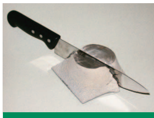
Lichtbogendrahtgespritzter Bolzen aus AlSi6, erhitzt in das Thixo-2-Phasengebiet und mit geringer Kraft zerteilt.
